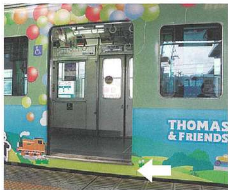
浜大津駅での石坂線用電車の様子。 ホームと電車のドアに段差がある
