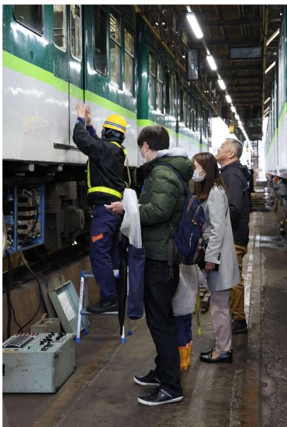
600形の床下を見学。装置点検の様子やハンマーを使った打音検査など、電車の安全を守る作業の一端を知ることができました。
