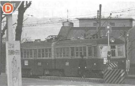
■びわこ号 名車「びわこ号」は、琵琶湖遊覧客のために天満橋～浜大津間を直通72分で結んだ。カーブの多い京津線で高速運転するため、連結部分に台車をつけた日本初の連節車。1970年まで活躍。写真Dは、ポールを揚げて蹴上駅付近を走る「びわこ号」。
